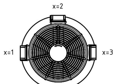
Auswahl der Klemmenkastenlage/
