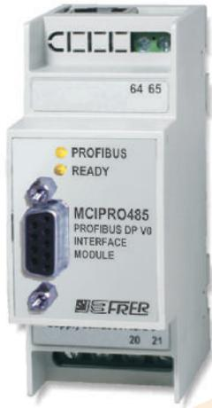
MCIPRO485 è un modulo di interfacciamento esterno per collegare uno strumento multifunzione FRER (dotato di interfaccia RS485 con protocollo ModBus RTU) ad un sistema Profibus DP V0. Può essere utilizzato nei casi in cui non sia previsto l'interfacciamento integrato nel prodotto, o per modificare in un secondo tempo il tipo di interfacciamento originale.
